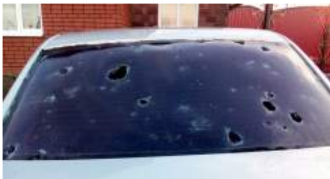
Рис. 27 — Последствия крупного града
